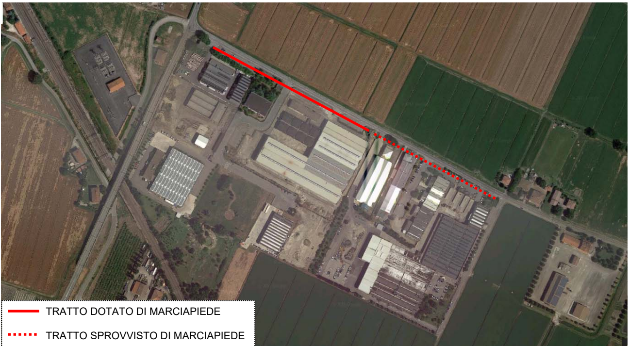
Figura 5- Dotazione attuale di marciapiedi nel tratto di via Bazzane interessato
